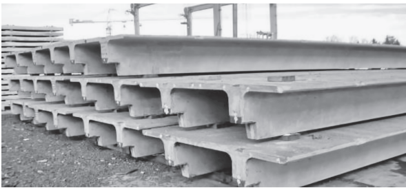
Hình 2. Các cấu kiện sàn chữ T đôi dự ứng lực
